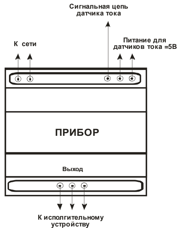
Рисунок 8.1 – Схема подключения прибора к сети, к датчикам тока и к исполнительному устройству
