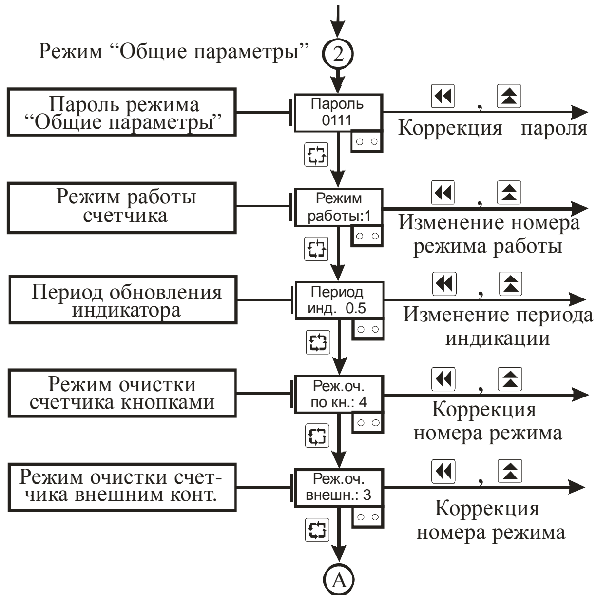
Рисунок 3.5 – Схема алгоритма работы прибора в режиме “Общие параметры”
